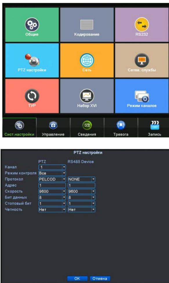
Рисунок 4.32 Конфигурация **PTZ** и **RS485** устройств в аналоговом и гибридном режимах.
