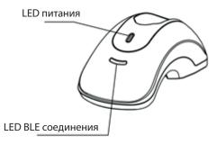
**Индикатор питания:** горит желтый светодиод, устройство рабоатет исправно. **Индикатор BLE соединения:** горит синий светодиод, соединение установлено
