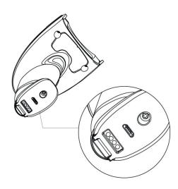
Зарядите сканер с помощью кабеля Micro USB. Красный светодиод сканера горит во время зарядки и гаснет при полной зарядке. Время зарядки: около 3~4 часов.
