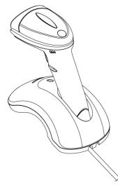
Убедитесь, что кабель USB подключен, установите сканер в подставку. Красный светодиод сканера горит во время зарядки и гаснет при полной зарядке. Время зарядки: около 3~4 часов.
