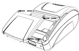
Рисунок 2. Крышка отсека для ФН и АКБ отделена от корпуса ККТ
