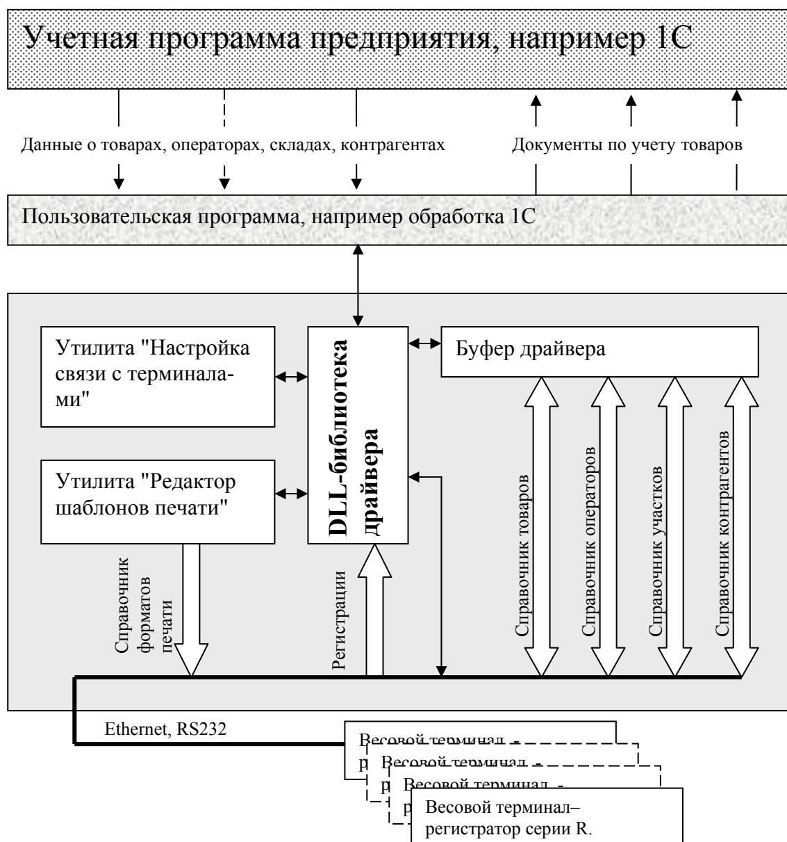
Рис. 2.1. Структурная схема работы драйвера "МАССА-К: Драйвер R."
