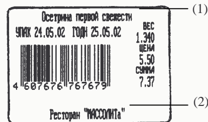
Рис. 10. Пример печати этикетки формата 58. Этикетка размером 40 x 30 мм, без препринта. Это минимально возможный размер этикетки, в полях “наименование товара” (1) и “магазин” (2) печатается только первая строка мелким шрифтом.
