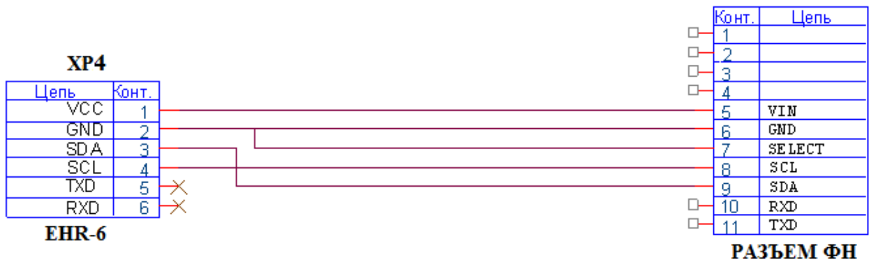
Рисунок 5 Кабель подключения ФН к ККТ
