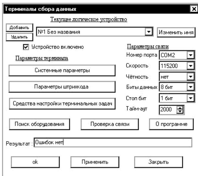
На визуальной странице свойств драйверов терминалов сбора данных «Zebex PDX-10/PDL-20» и «Orticon» доступны для настройки следующие свойства:
