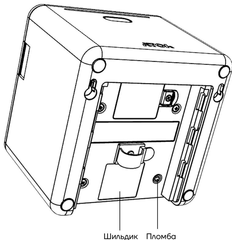
Рисунок 1. Расположение шильдика и пломбы на корпусе ККТ
