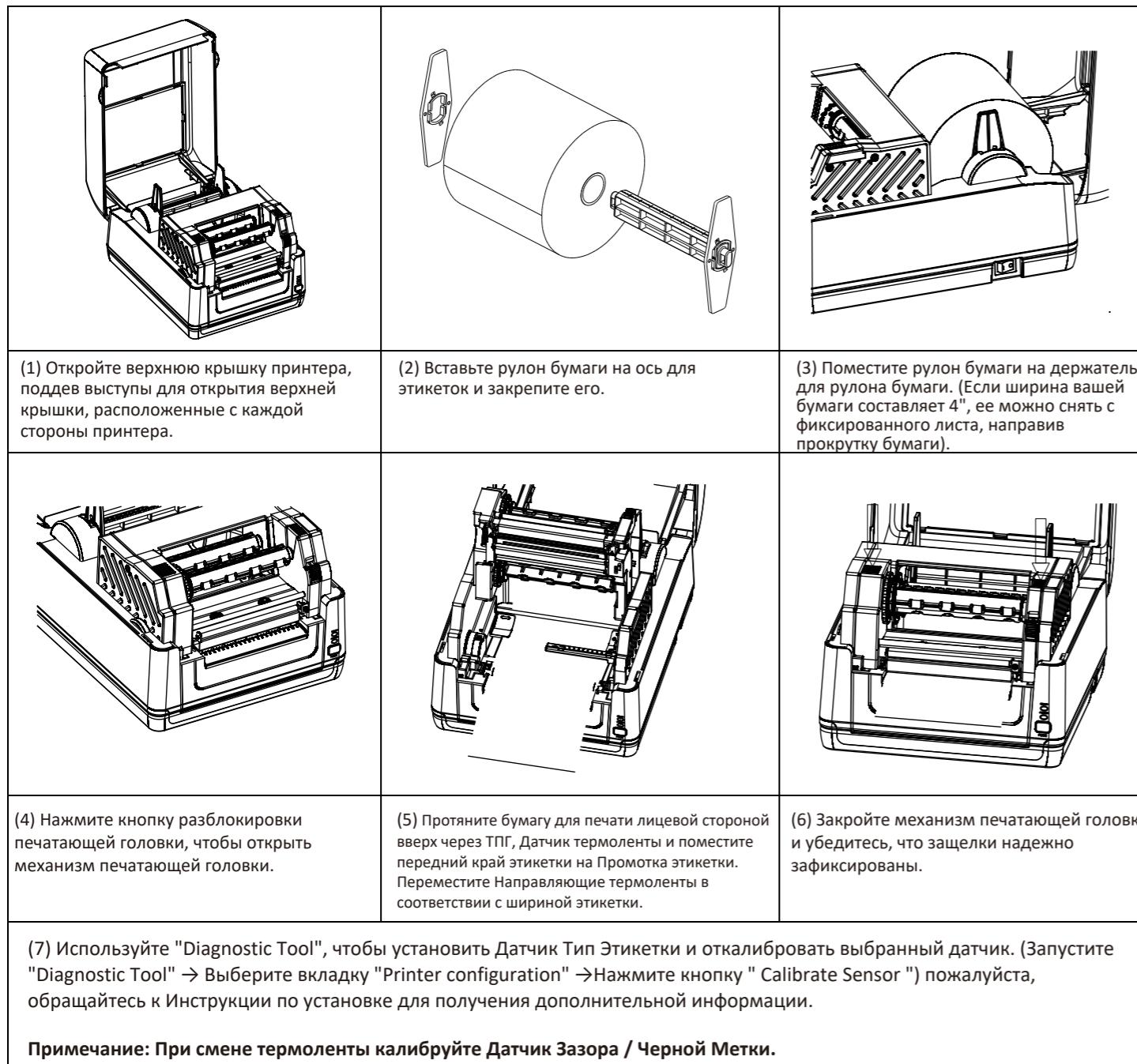
Примечание: При смене термоленты калибруйте Датчик Зазора / Черной Метки.
