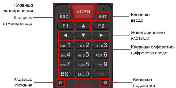
Рисунок 20. Клавиатура устройства (основные клавиши)
