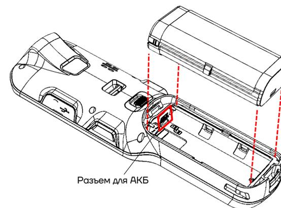
Рисунок 8. Аккумулятор извлечен из отсека
