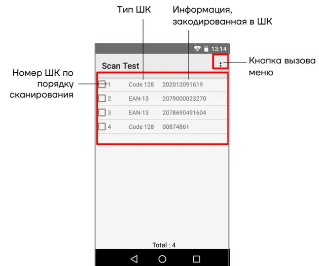
Рисунок 26. Раздел **Scan Test**
