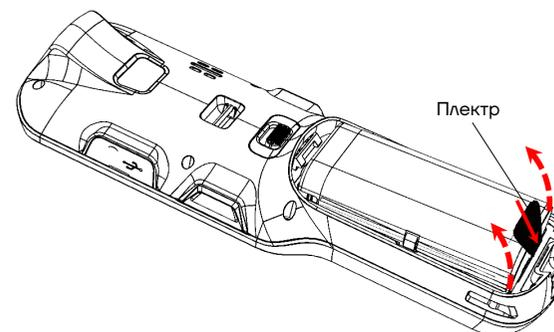
Рисунок 7. Извлечение АКБ из корпуса устройства
