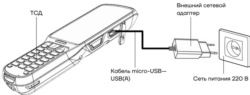
Рисунок 3. Схема подключения ТСД к сети питания
