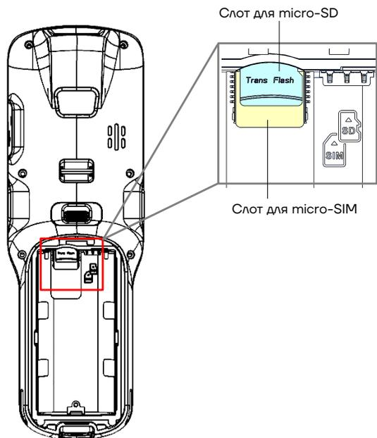
Рисунок 11. Установка micro-SD/micro-SIM (опционально)
