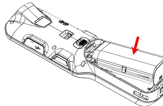
Рисунок 9. Установка АКБ в корпус устройства
