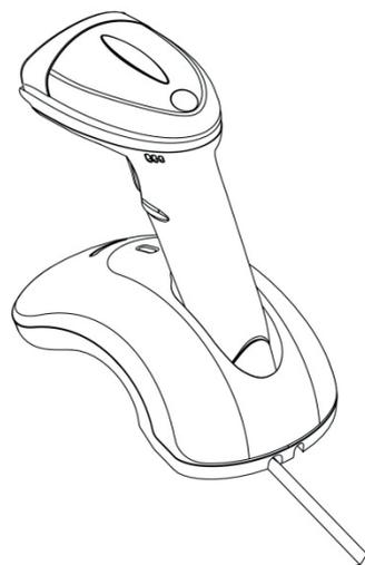
Убедитесь, что кабель подключен, установите сканер в подставку. Красный светодиод сканера горит во время зарядки и гаснет при полной зарядке. Время зарядки: около 3~4 часов.
