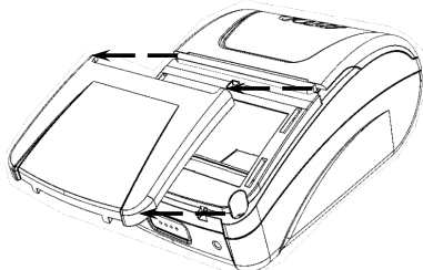
Рисунок 3. Крышка отсека для ФН отделена от корпуса ККТ
